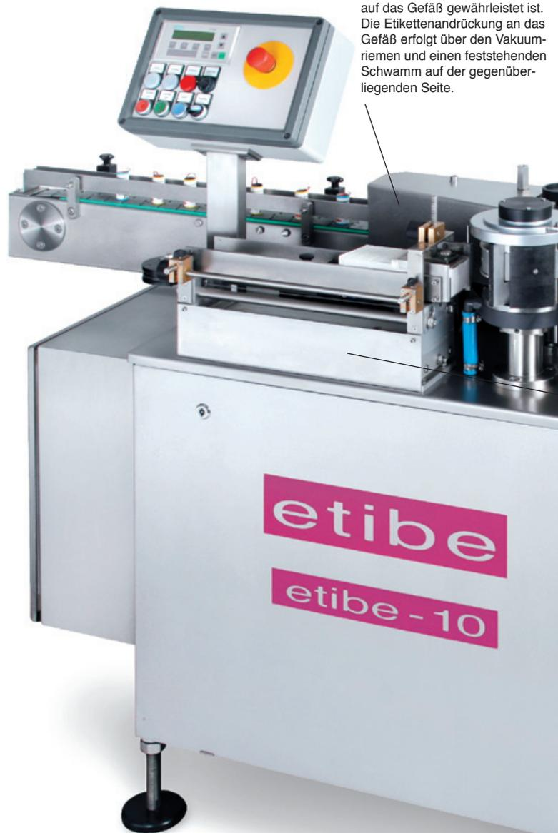
Der Etikettiervorgang wird durch einen Reflexlichttaster im Schneckenbereich ausgelöst. Sollten Störungen beispielsweise durch Übergrößen oder Verklemmen der Gefäße auftreten, wird die Maschine abgeschaltet um Schäden vorzubeugen.
